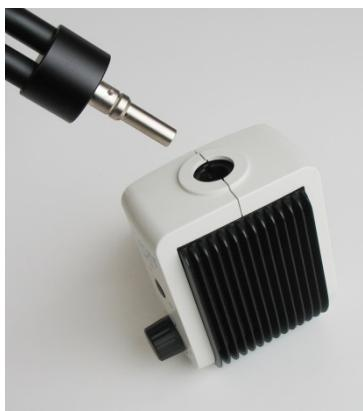
Der Lichtleiter wird bis zum Anschlag in die Lichtleiteraufnahme (1) eingeschoben. Um einen festen Sitz und eine optimale Ausleuchtung zu gewährleisten, muß dabei die Nut in der Feder einrasten.
