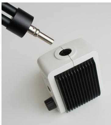
La guía de luz se inserta en la toma de la guía de luz (1) hasta el tope. Para asegurar un ajuste perfecto y una iluminación óptima, la guía de luz debe encajar en la ranura (se oye un pequeño clic).
