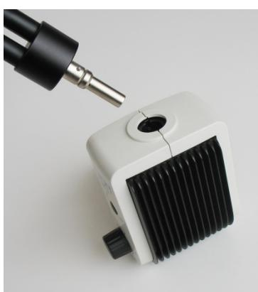
A guia de ondas ópticas é inserida totalmente, até encostar, na interface de saída ótica (1). Para assegurar o posicionamento firme e uma iluminação ótima é necessário que o entalhe fique engatado na retenção.
