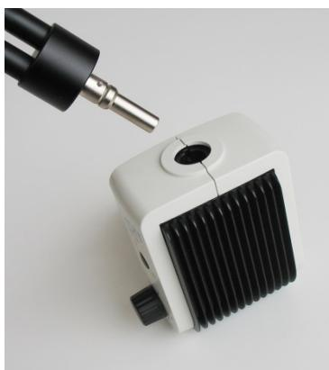
Le conducteur de lumière sera introduit dans l'entrée de la source (1) jusqu'à la butée. Pour permettre un éclairage optimal ainsi qu'une bonne fixation du conducteur, l'encoche doit être clipsé dans le ressort.
