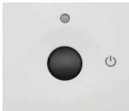
Encienda/apague el equipo KL 300 LED oprimiendo el interruptor de encendido/apagado (3).
